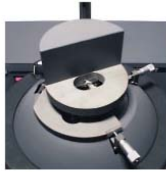
圖 6. 低電流STM量測頭(3pA-5nA) 操作範圍: 3pA-5nA 前置放大器雜訊: <1.5 pA 頻寬: 5.5 kHz.
