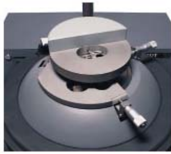
圖 5. 標準STM量測頭 (30pA-50nA) 操作範圍: 10pA-10nA 前置放大器雜訊: approx. 5 pA 頻寬: 12 kHz.
