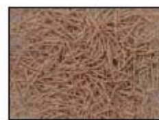
圖三、鉛筆切屑(左圖為滾刀銳利時的切屑,右圖為滾刀磨耗後的切屑)
